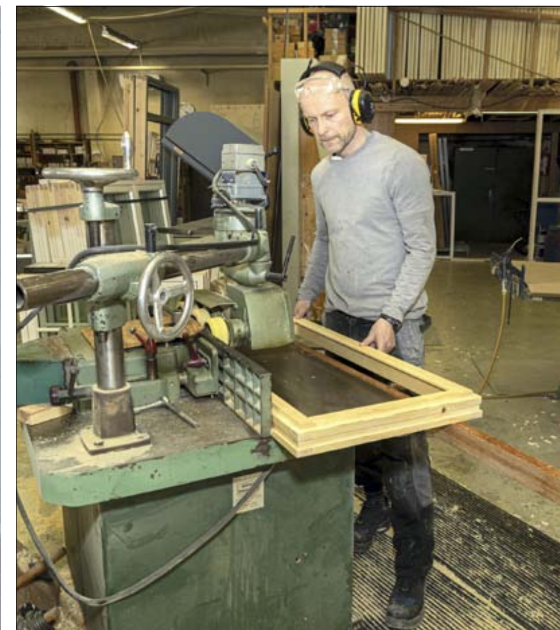
VINDU: Leiv Fjeldstad sørger for at vinduene blir frest korrekt før det blir satt inn glass.
